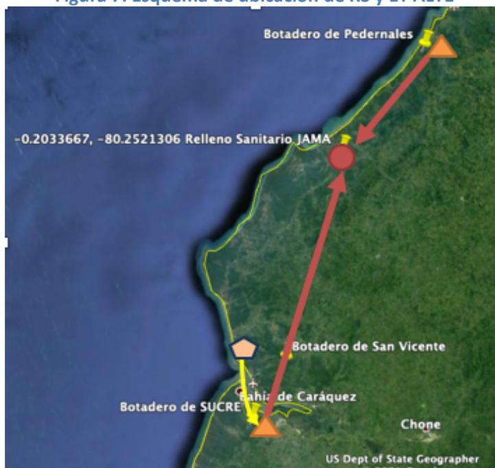
En el gráfico se puede observar la ubicación propuesta de la alternativa 1, el aprovechar la existencia del Relleno Sanitario de Jama, para ampliar el área de plataformas y sistemas de captación de lixiviados y biogás para que pueda recibir los residuos de toda la mancomunidad, con la ventaja de que ya se cuenta con infraestructura básica que se puede aprovechar. Por otra parte el terreno tiene 40 Ha, suficiente para operar en la vida útil estimada de 20 años.
